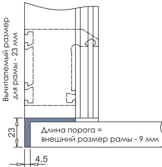
Крепление соединителя порога производится пятью саморезами 4,2x25
